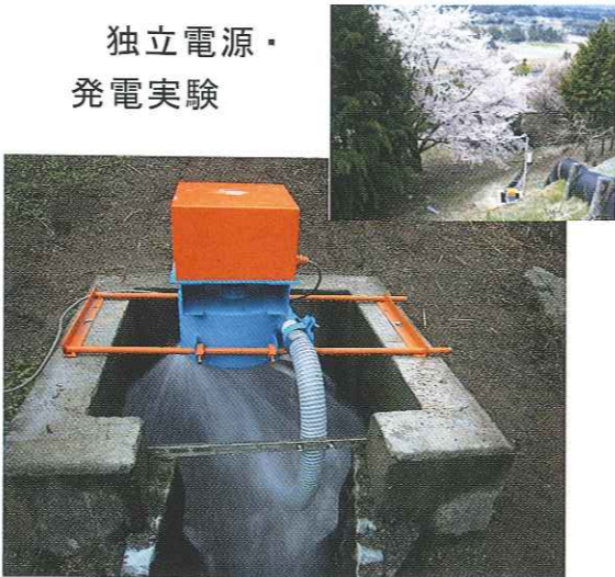
青色部分がタービン、直結軸でオレンジ色部分の発電機をダイレクトに駆動 桜満開の設置場所付近より天竜川を望む
