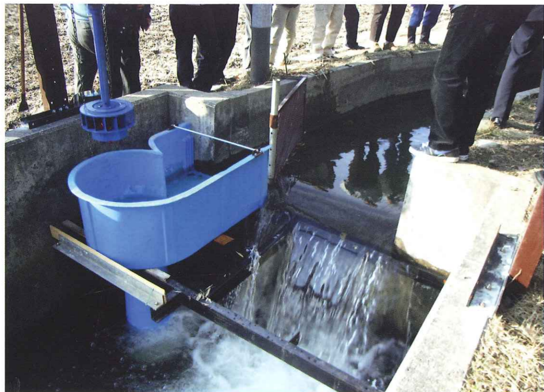
写真1: ベトナム製「パワーパル」(プロペラ) を農業用水に設置
