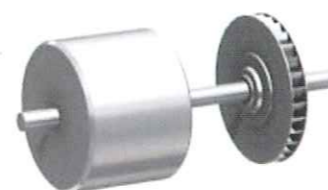
内蔵発電機とクロスフロー式水車 (CG)
