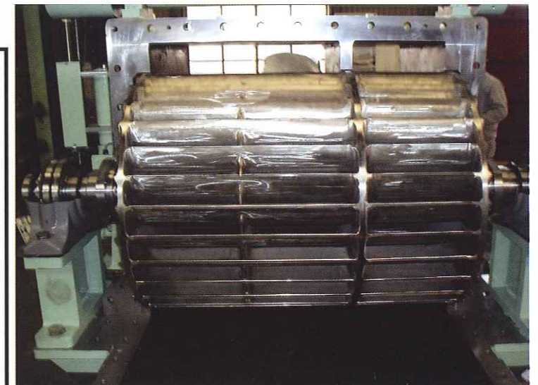
クロスフロータービンのランナを取り出したところ
