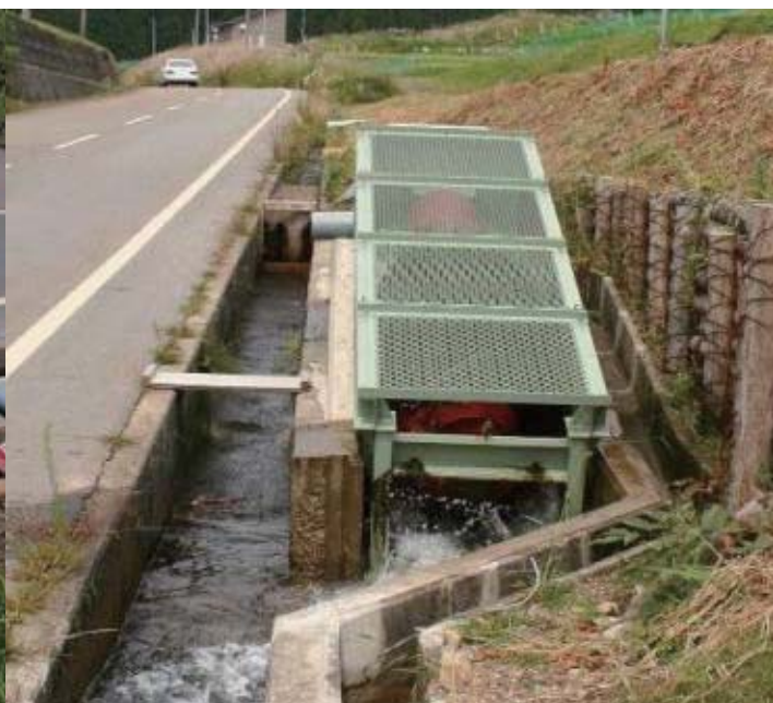
【写真6】らせん型2号機(篠田製作所・0.8kW)
