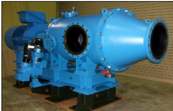
32kW 直結リンクレスフランシス水車・発電機
