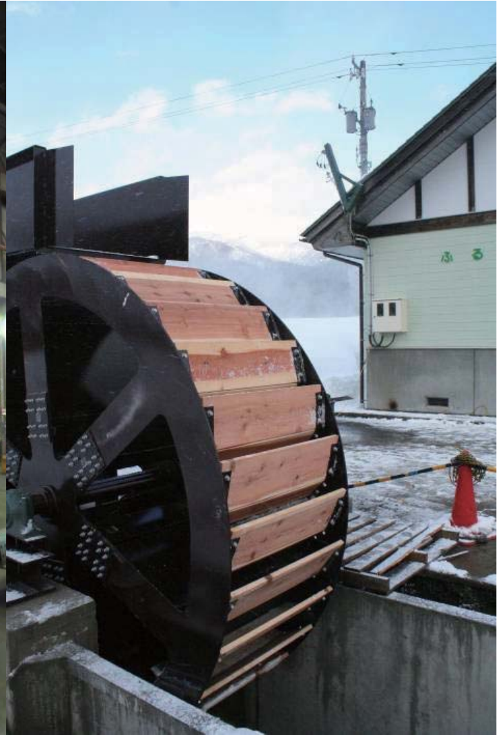
【写真8】設置後の上掛け水車
